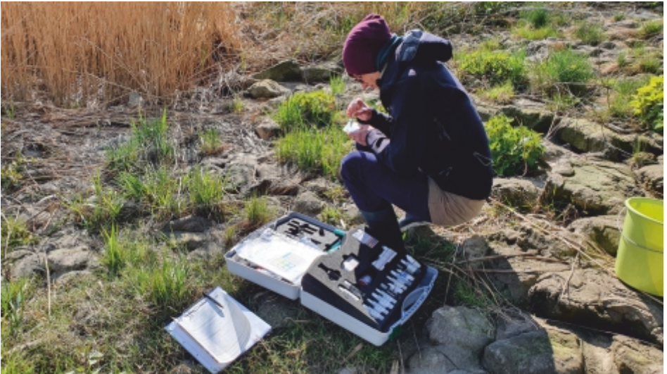
Bild oben: Einsatz eines Wasseranalysekiters zur Bestimmung chemisch-physikalische Parameter.
